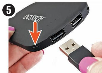
5. 使用USB线连接电池。当USB线插好时，电池将自动开始工作。Falcon将自动进行简单的自我检测（每次开机时该自检都将自动进行）。按下电源指示按钮（如图上红色箭头所示），保证电池向Falcon正常供电。亮起灯的数量表示剩余电量百分比。
