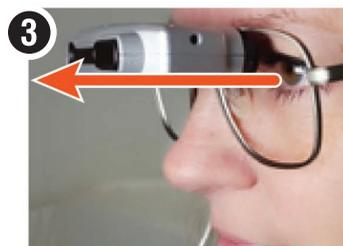
3. 请患者稍稍向下低头，目光透过目镜。调整视角，直至镜筒与学生视线成一条直线（如图上红色箭头所示）。
